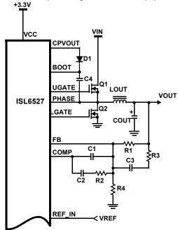
FIGURE 2. OUTPUT VOLTAGE SELECTION
