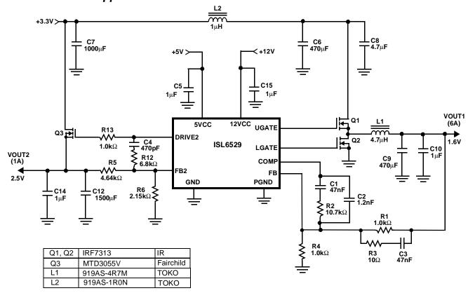
FIGURE 8. POWER SUPPLY APPLICATION CIRCUIT FOR A GRAPHICS CONTROLLER
