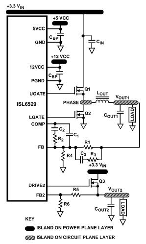
FIGURE 7. PRINTED CIRCUIT BOARD POWER PLANES AND ISLANDS
