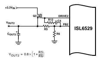
FIGURE 4. OUTPUT VOLTAGE SELECTION OF THE LINEAR
